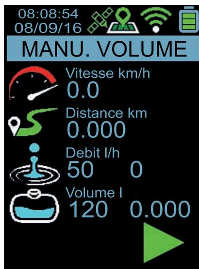
Dans ce mode de fonctionnement, l'opérateur règle le débit en litre par heure à épandre.
